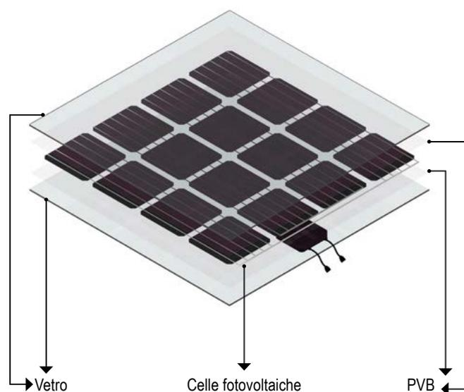
Sunlight, grazie alla sua versatilità, offre una soluzione innovativa per la produzione di energia sostenibile integrando nel tetto vetri fotovoltaici stratificati. Le celle fotovoltaiche di Sunlight sono strategicamente disposte a griglia, sfruttando al massimo la superficie disponibile. In una configurazione di dimensioni 6x4,5 metri, Sunlight è in grado di generare una potenza notevole di 1,4 kW.
